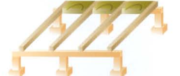
設備工事: 根太間ストレートパネルの取付 (弊社)
